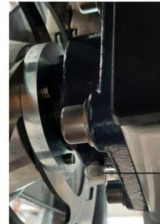
Schmieren Sie das Flansch- bzw. Radlager von Zeit zu Zeit oder spätestens nach 1000km mit einer Fettpresse und herkömmlichen Maschinenfett.
