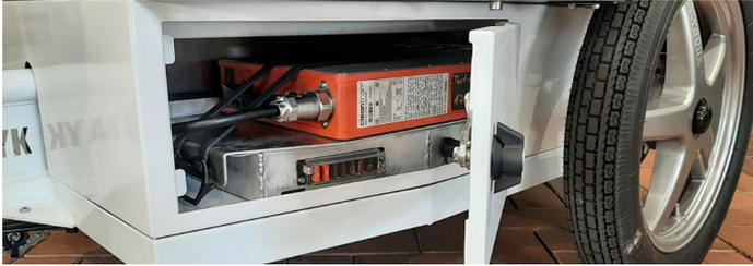
Das Cargobike ist optional mit Akkus von **CLEANTRON** oder **AES** ausgestattet. (Die Ausführung mit AES-Akkus hat keine Ladebuchsen am Heck.)
